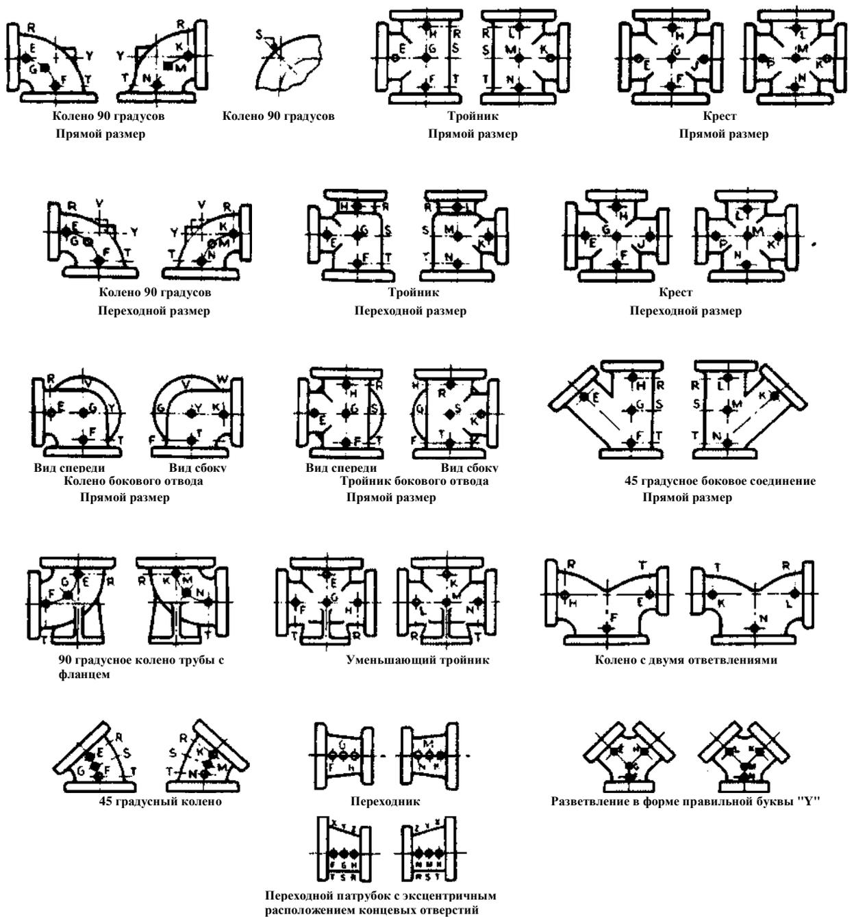
ОБЩЕЕ ПРИМЕЧАНИЕ: Приведенные выше схемы показывают вид одинаковых фитингов и представляют фитинги симметрической формы, за исключением колена бокового отвода и тройника бокового отвода (прямые размеры). Схемы носят только иллюстративный характер и не предполагают конкретную конструкцию (Смотрите параграф 6.12).
